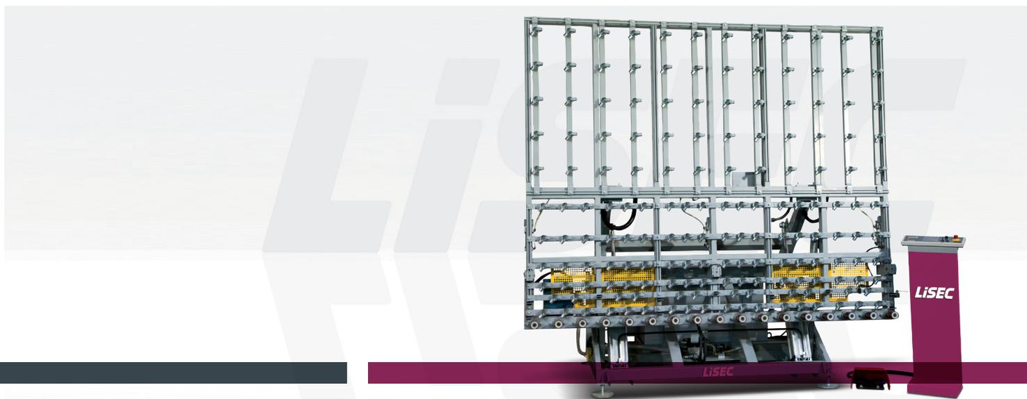
Стол обеспечивает быстрый и надежный наклон листов стекла и/или изделий. Изделия подаются вертикально и наклоняются посредством специальной коленно-уровневой наклоняемой системы, при этом установка стола перемещается на 800 мм вперед. Это позволяет экономить пространство при расстановке линии в цехе. Противовесы на опорных роликах гарантируют их линейное положение, в то время как стол находится в вертикальном положении.
