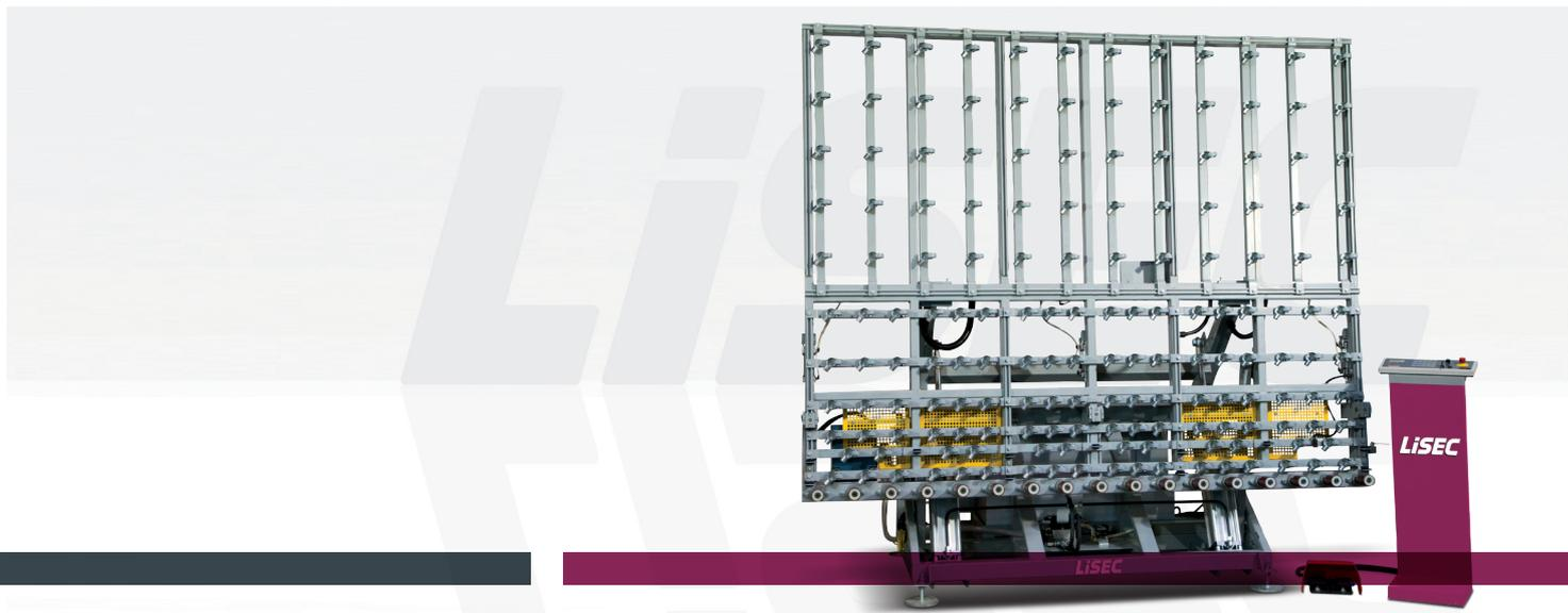
Schnelles und sicheres Umlegen von Glasscheiben bzw. Isolierglaselementen. Das Umlegen der vertikal einlaufenden Elemente erfolgt über ein spezielles Kniehebel-Schwenksystem zum Erreichen einer um 800 mm vorgelagerten Position der Referenzkante zur Glaslauflinie. Das ermöglicht eine platzsparende Anordnung von Isolierglaslinien. Ausgleichsgewichte an den Stützrollen sorgen für die Beibehaltung ihrer linearen Position bei vertikaler Tischstellung.
