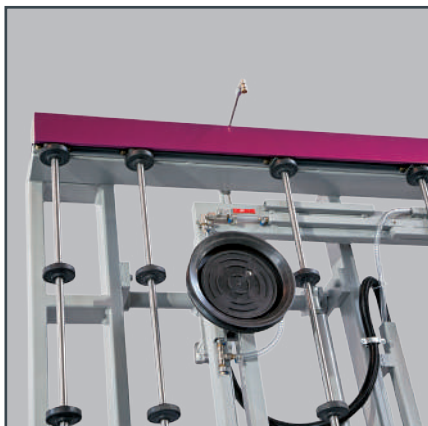
Vereinzelungseinheit mit Düse und Sauger.
