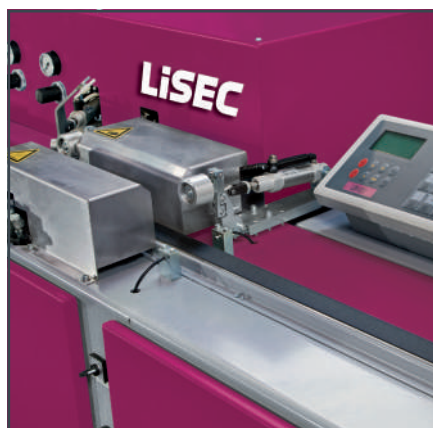
Автоматическое измерение ширины дистанционной рамки
