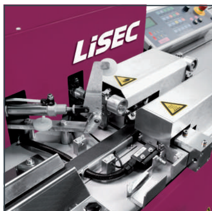
Устройство для обработки радиусных форм вручную
