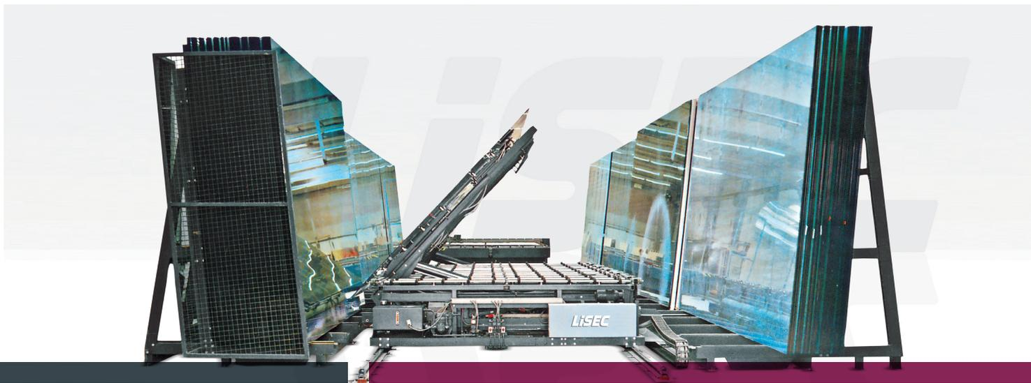
Двухсторонняя погрузочная станция поднимает листы стекла с пирамид, расположенных по обеим сторонам и автоматически перемещает на стол резки. Как поворотный механизм, так и рамы с вакуумными присосками приводятся в движение гидравлическим приводом. Возможно исполнение подвижной версии, что позволяет загружать стекло с более чем двух пирамид.
